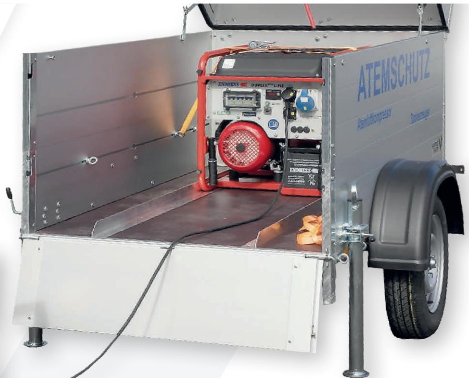
Der nach dem Membranverdichter-Prinzip ohne Ölschmierung arbeitende Kompressor ermöglicht kontinuierliche Luftversorgung für Atemschutzgeräte. Die verdichtete Luft wird zusätzlich durch eine dreistufige Filtereinheit von Gerüchen und Staubbelastungen aus der Ansaugluft gereinigt.
