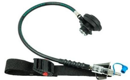
Beschreibung:            Durch den Lungenautomat erhält die Atemschutzgerät-tragende Person bei Bedarf Atemluft in bedarfsgerechter Menge. Der Lungenautomat wird am Atemanschluss (z.B. Vollmaske BRK 820) befestigt. Die Luftversorgung erfolgt über den Druckluft-Zuführungsschlauch DZS 9 und einer geeigneten Druckluftquelle mit Atemluft nach DIN EN 12021.
